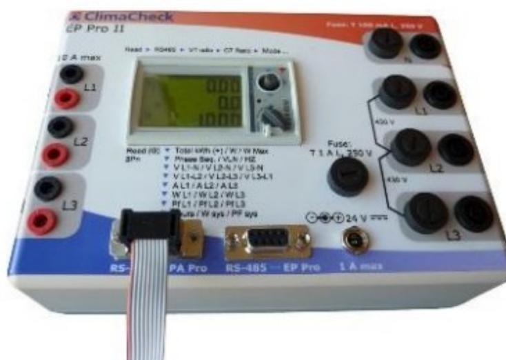
Figura 3.8 – Analisador de energia utilizado na bancada experimental
