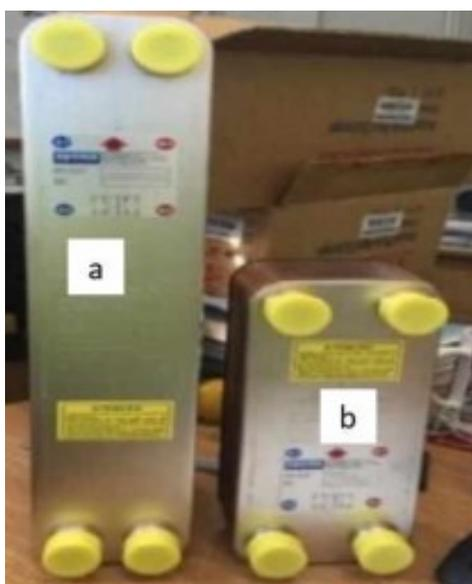
Figura 3.4 – Trocadores de calor de placas brasadas Apema, modelos AEK 070-40 (a) e AEK 095-60 (b)
