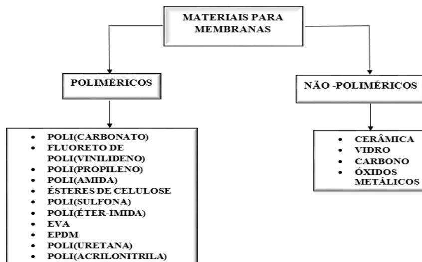
Figura 2.4 – Materiais usualmente empregados na produção de membranas. (Baseada em Strathmann, 1981; Scott, 1995; Habert et al., 2006; Beltsios et al., 2008)
