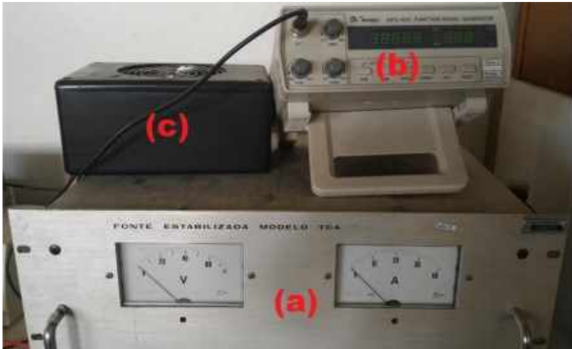
Figura 5: Fonte, modulador de sinais e pulsador de sinais utilizados.
