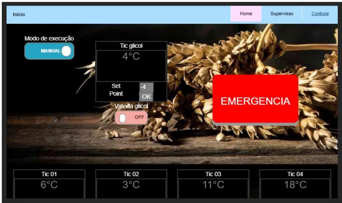
Figura 33 - Interface de controle do app web para telas entre 7 e 10 polegadas
