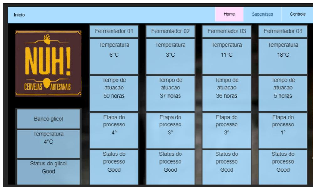
Figura 31 - Interface de supervisão do app web em telas entre 7 e 10 polegadas
