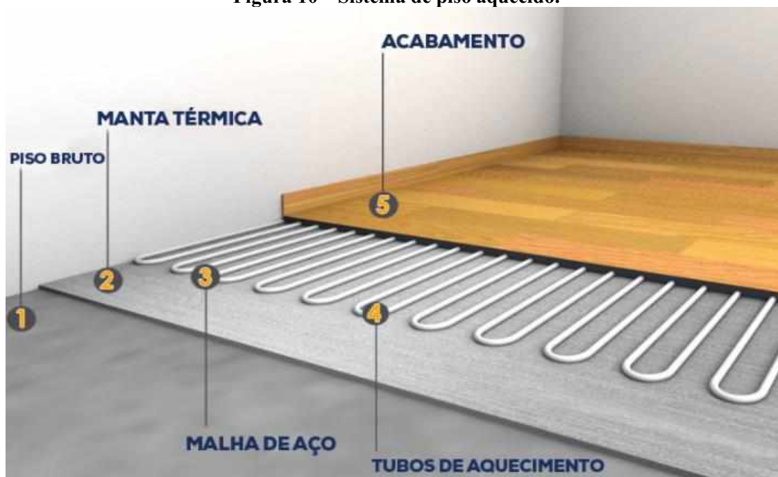
Figura 10 – Sistema de piso aquecido.
