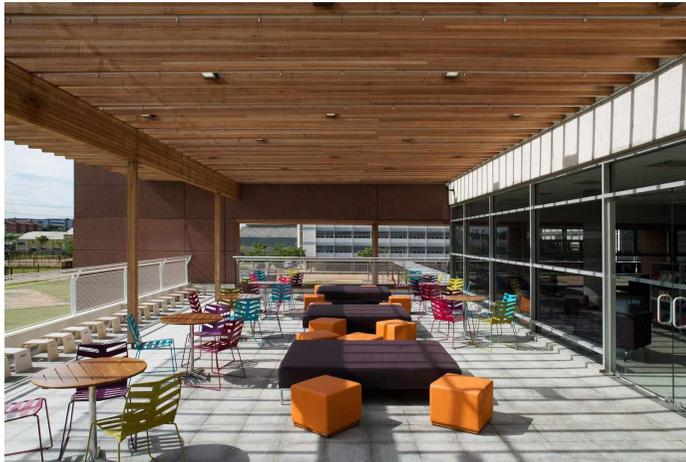
**Figura 35:** Terraço do pavimento superior com cobertura em pergolado de madeira e policarbonato.
