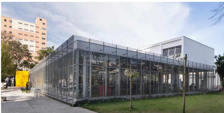
**Figura 29:** A volumetria da Biblioteca conta com brises metálicos que também servem como proteção do edifício e tornam o uso de grades e outros bloqueios desnecessário.
