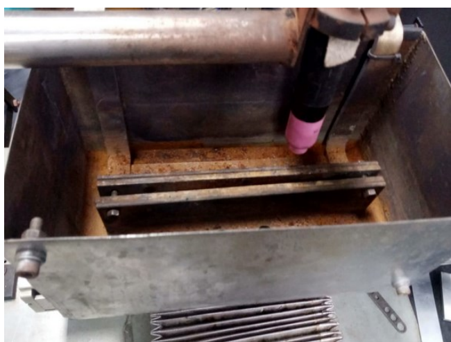
Figura 3.6 - Mecanismo de fixação da peça. Fonte: O autor
