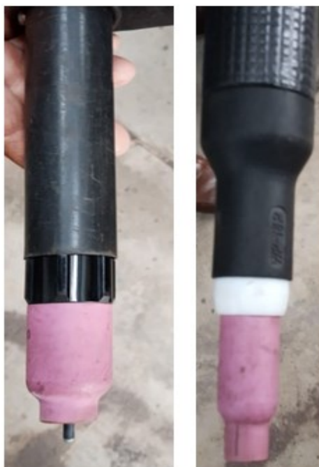
Figura 3.4- Tochas para os eletrodos de 4 e 1.6 mm. Fonte: O autor
