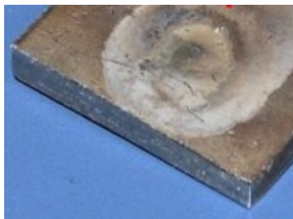
Figura 2.3 - Região esbranquiçada devido a limpeza catódica. Fonte: O autor
