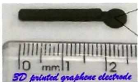
Figura 5: Eletrodo impresso 3D incorporado com grafeno
