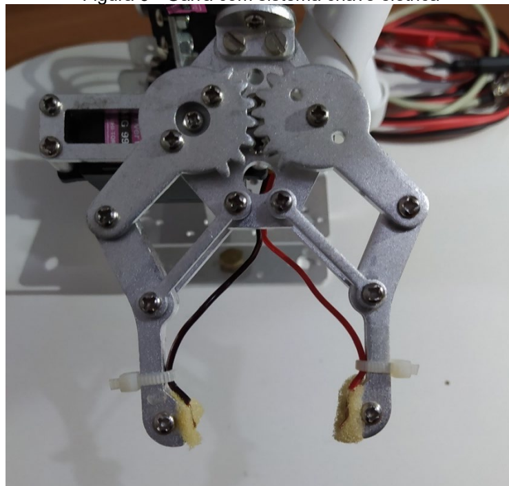
Figura 3 - Garra com sistema chave elétrica
