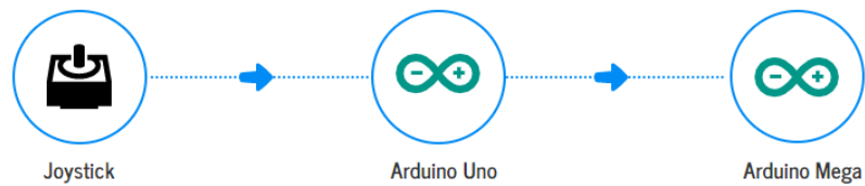
Figura 16 - Ilustração esquemática da primeira parte do sistema - Joystick.
