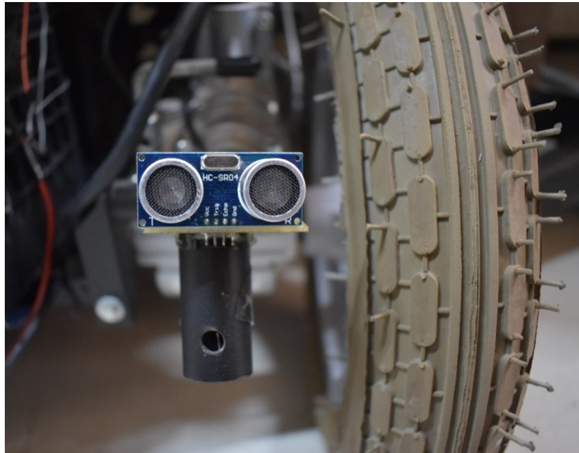
Figura 28 - Sensor ultrassônico posicionado na parte traseira da CRM.
