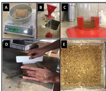
Figura 1. Montagem da caixa gerbox com substrato areia. A) peso considerado para cálculo da capacidade de retenção de água; B) amostra de areia em funil para recepção da água; C) volume de água escoado após 15 minutos; D) caixa gerbox preenchida com área e nivelada, e E) caixa gerbox finalizada para recebimento das sementes. GEPCA/ICIAG/UFU. Uberlândia-MG, 2019.
