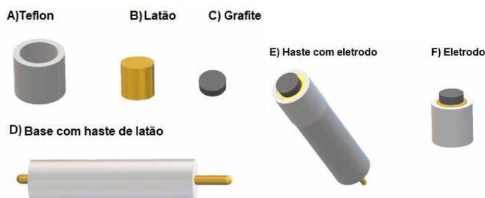
**FIGURA 9:** Representação da construção do eletrodo de trabalho. (A) base de Teflon®, (B) encaixe de Latão, (C) disco de grafite (99,9995% de pureza, Alfa Aesar), (D) base com haste de latão, (E) haste encaixada ao eletrodo, (F) eletrodo (autoria própria).
