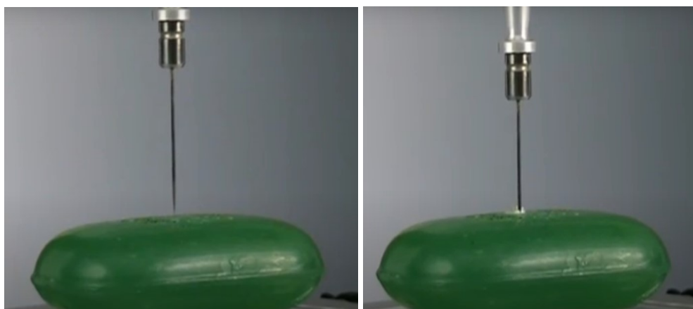
Figura 22. Compressão por penetração da sonda nos sabonetes.
