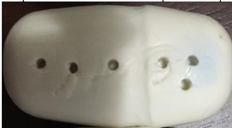
Figura 23. Sabonete após o teste de dureza com os furos após sofrer compressão da sonda.
