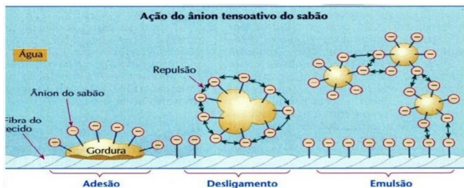
Figura 9. Formação da micela na interação entre o sabão, gordura e água.
