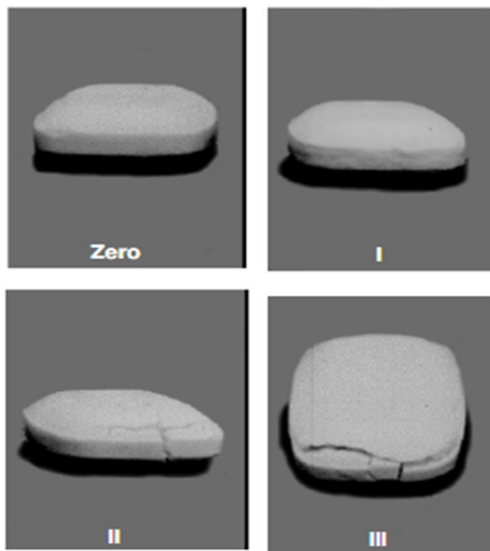
Figura 17. Escala para avaliação de rachaduras.
