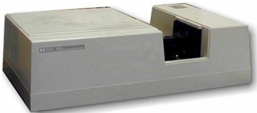
Figura 11- Espectrofotômetro tipo diode array HP8452A. (Fonte: Evisa. 2003)
