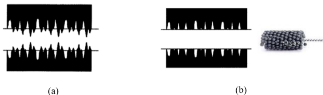
Figura 09: (a) Representação esquemática do perfil de uma superfície cilíndrica antes do processo de brunimento flexível (b) e após processo com brunidor flexível (VERTEC apud PEREIRA, 2016).
