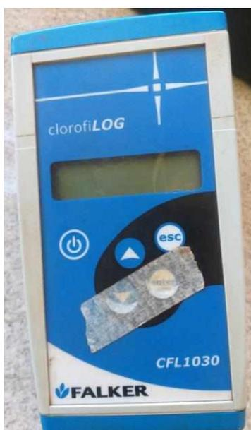
Figura 6. Clorofilômetro - ClorofiLOG Falker – Brasil.
