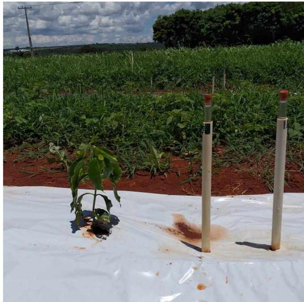
Figura 7. Bateria de tensiômetros na área experimental.
