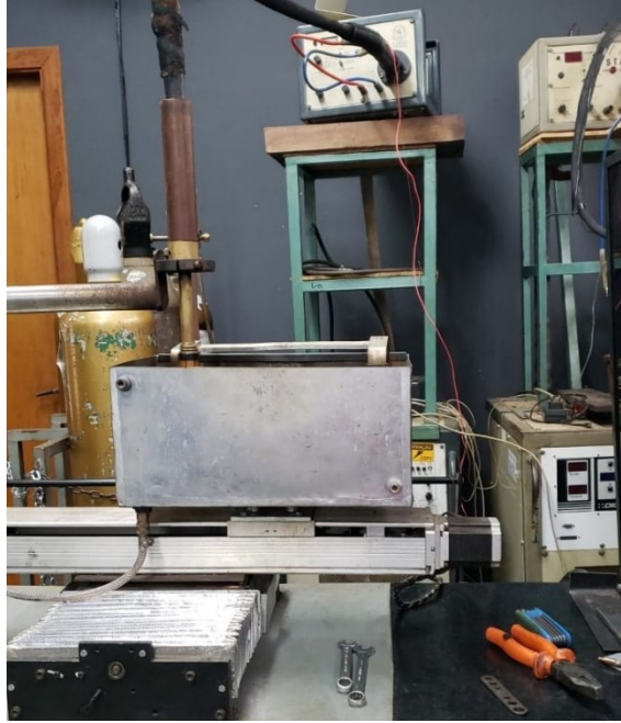
Figura (3.2) – Sistema mecânico de controle de movimentação da tocha e da mesa de soldagem.
