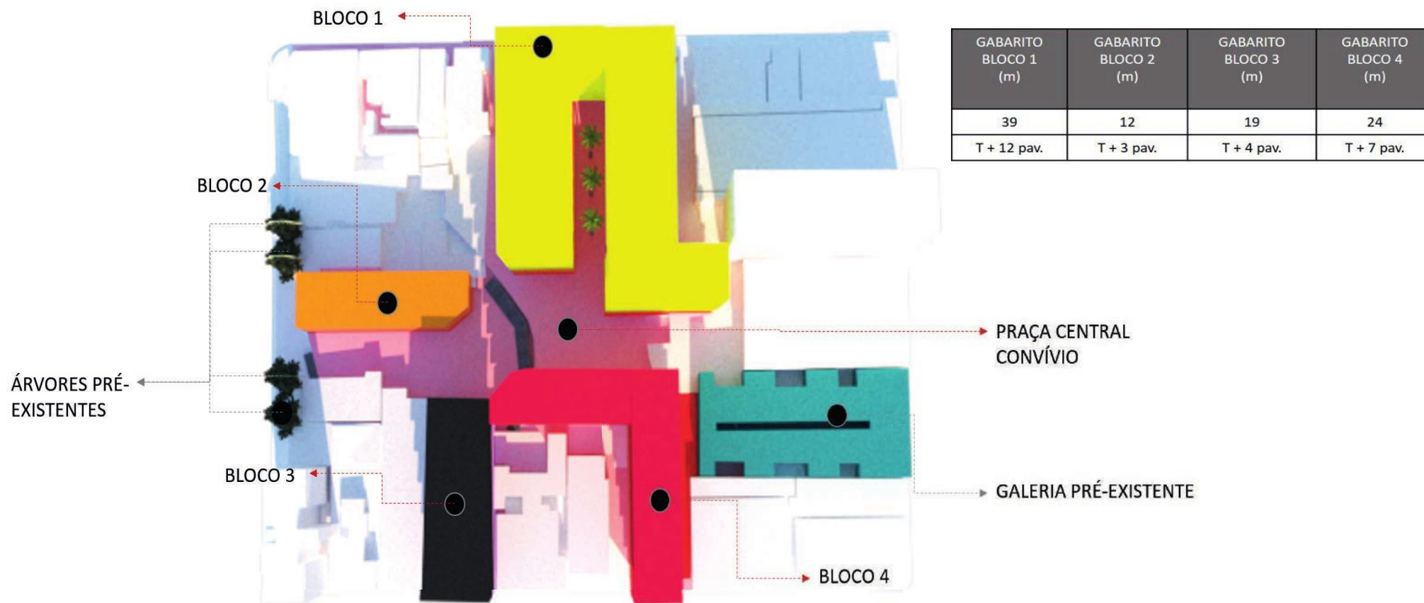
Figura 40: Implantação e indicação da altura dos blocos
