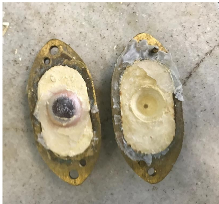
Figura 45 - Mufla aberta após polimerização da resina acrílica incolor
