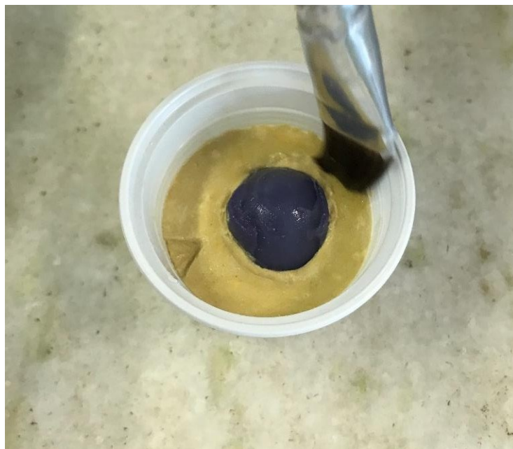
Figura 11 - Retenção e vaselina na parte inferior e molde
