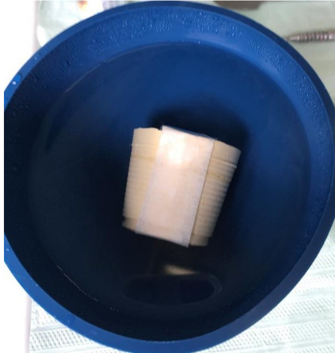
Figura 16 - Plastificação da cera em água quente
