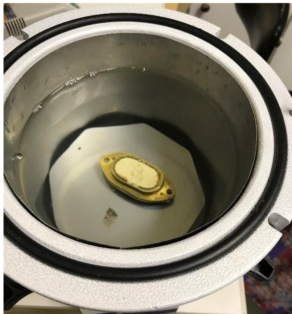
Figura 39 - Mufla na panela polimerizadora
