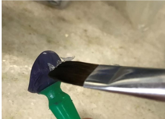
Figura 8 - Molde sendo vaselinado
