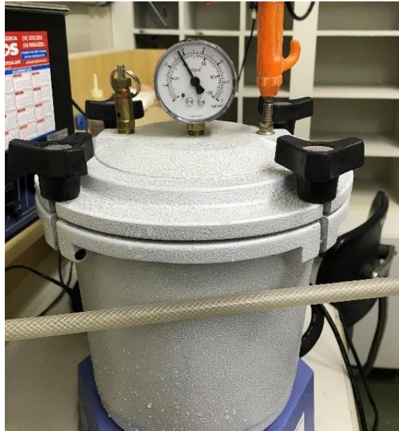
Figura 40 - Panela polimerizadora em 40 Libras
