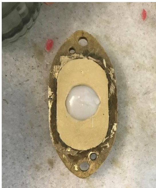
Figura 37 - Resina acrílica em posição
