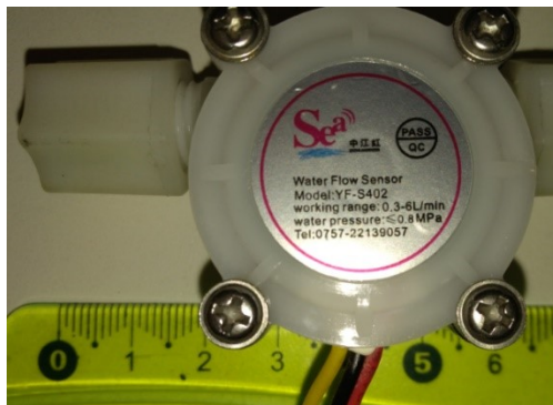
Figura 18. (a). Sensor de efeito Hall modelo YF-S402. (b). Sensor aberto mostrando detalhe do rotor.
