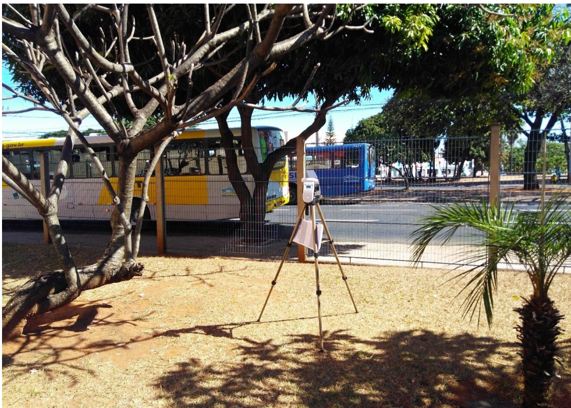
Figura 3 – Local de medidas e equipamento Aeroqual montado para medição. Fonte: próprio autor.
