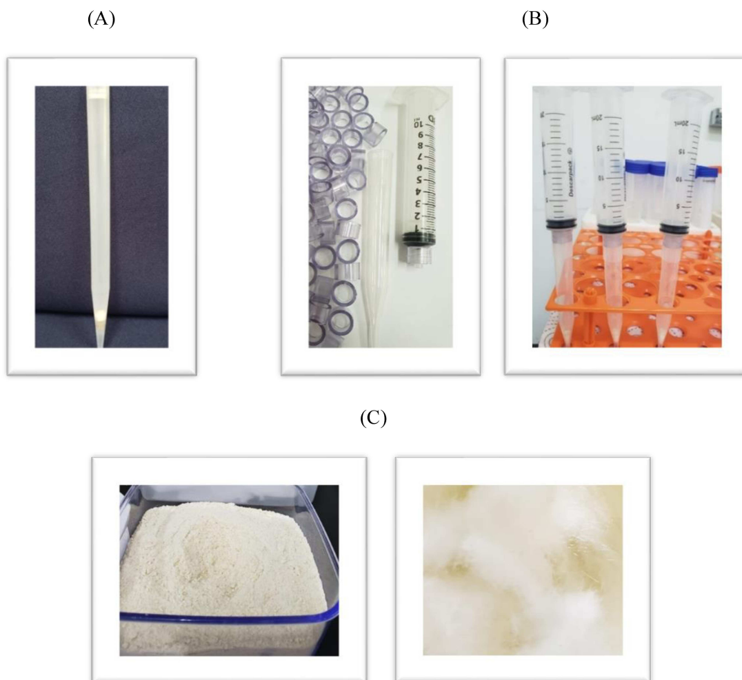
Figura 3: (A) Dispositivo DPX comercial 5 mL; (B) Dispositivo DPX adaptado: conector de tubo de polietileno, ponteira de micropipeta tipo Gilson de 5 mL e seringa 20 mL; (C) Adsorvente de pó de polpa de sementes de Moringa oleifera Lam. e lã de vidro. Fonte: Próprio autor.
