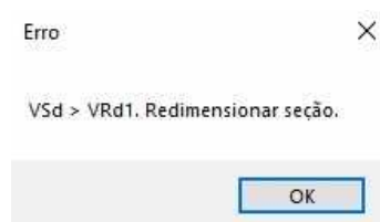
Figura 33 – Erro de verificação da força cortante
