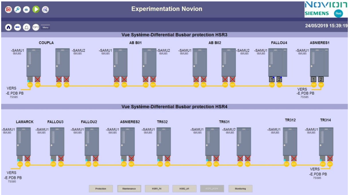
Figura 17 - Vista do sistema proteção diferencial de barramento
