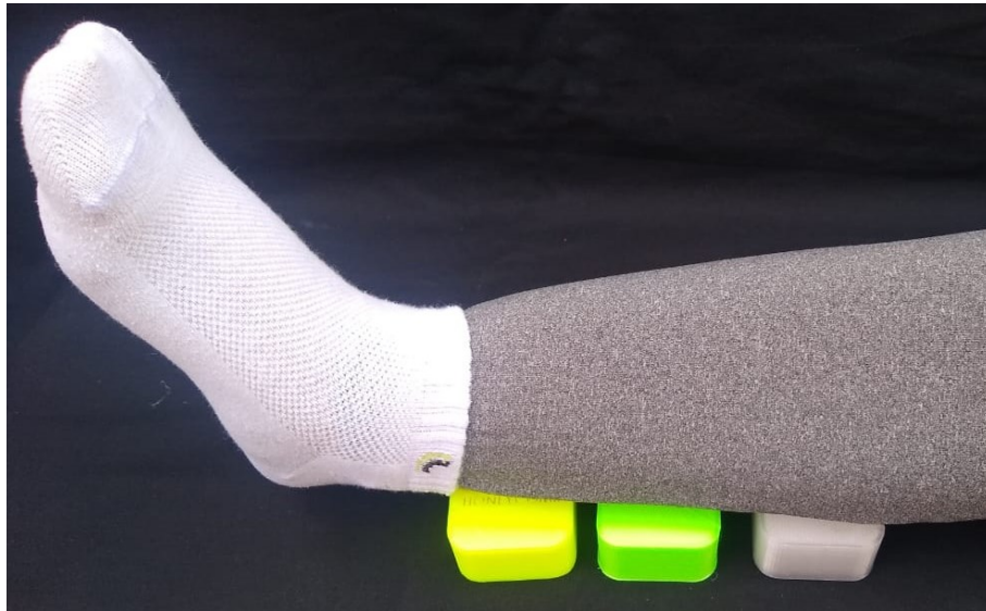
Figura 24 - Posicionamento da perna em relação às amostras para radiografia. Fonte - Acervo próprio.
