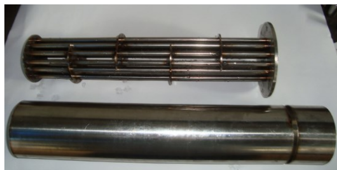
Figura 14 - Foto tirada dos detalhes internos do TCCT em estudo.
