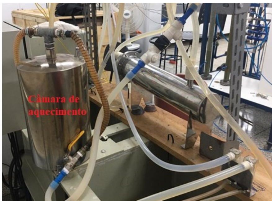
Figura 16 - Visão da unidade experimental explicitando a câmara de aquecimento de água.
