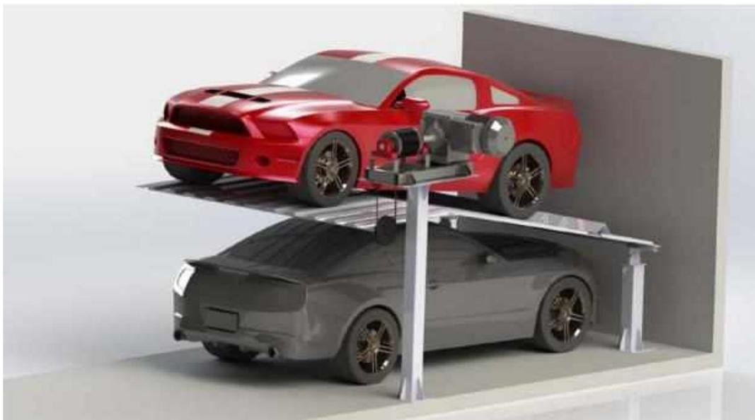
**Figura 26** - Dispositivo Duplicador de Vagas de Garagem
