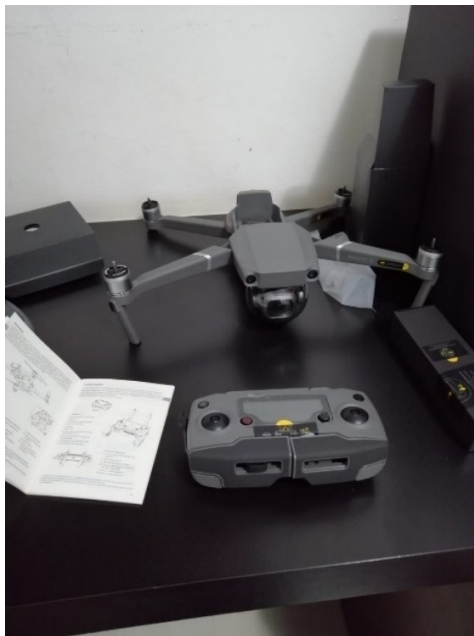
Figura 3 - RPA DJI Mavic 2 Pro com câmera Hasselblad Sensor CMOS 1" 20 MP
