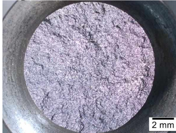
Figura 19 - Fratura frágil de amostra de ferro fundido cinzento, ensaio de tração.
