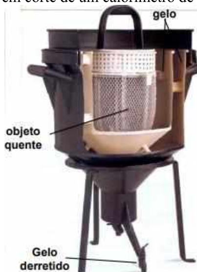
Figura 11 - Visão em corte de um calorímetro de Lavoisier e Laplace.
