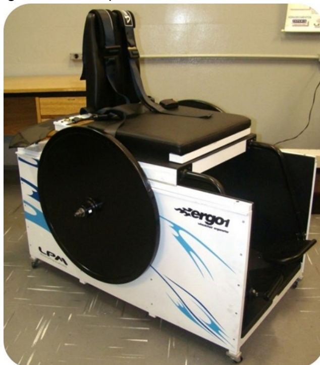
Figura 4: Protótipo de cadeira de rodas ERGO1
