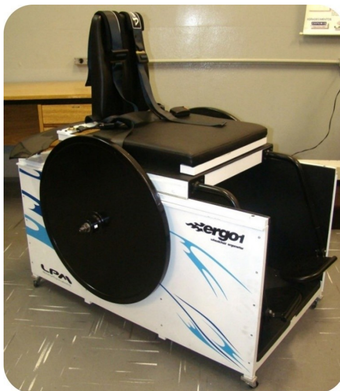
Figura 1 Protótipo do ergômetro para cadeirantes denominado ERGO1
