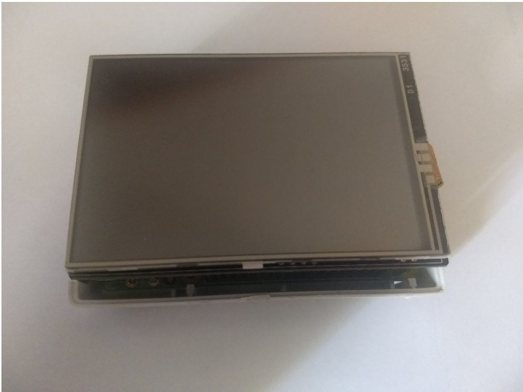
Figura 30 – Tela Sensível ao Toque de 3,5 polegadas.
