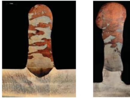
**Figura 2.3** - Seções transversais de reforçadores aeronáuticos com variação de material, usando aço e liga de cobre. Variação ao longo do comprimento (esquerda) e variação ao longo da espessura (direita) (extraído de Dunning *et al*, 2014).
