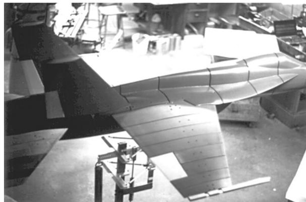
**Figura 1.3** - Modelo experimental de *flutter* para ensaio em túnel de vento. (extraído de NASA Aeroelasticity Handbook, 2006).
