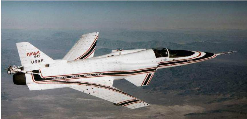
**Figura 2.2** - Aeronave experimental X-29, com conceito de enflechamento negativo. (cortesia da NASA).
