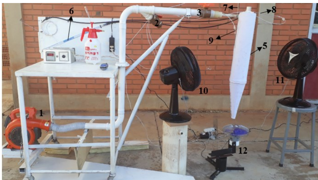
Figura 3.5 – Unidade experimental do sistema de resfriamento ciclônico-psicrométrico.
