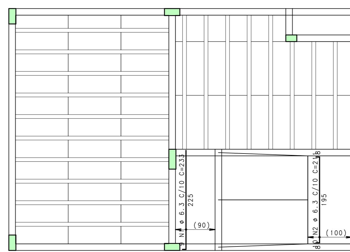
Detalhe genérico do alojamento de armaduras positivas
