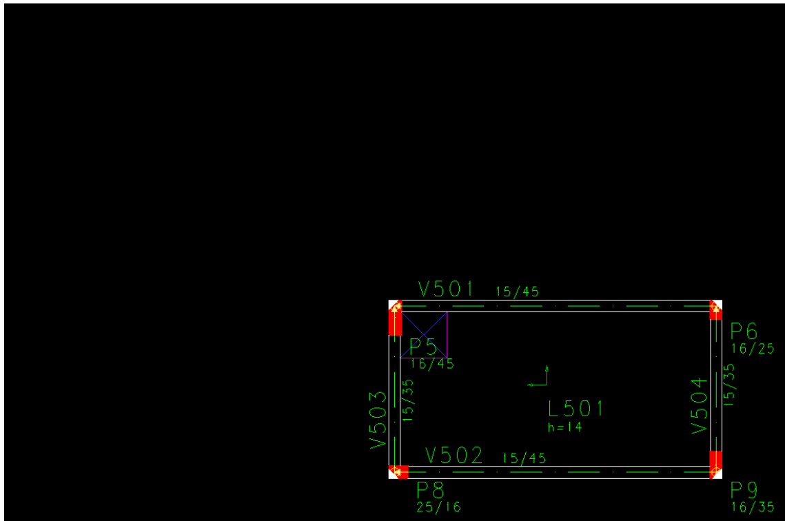
Figura 7.10 – Modelador estrutural do Reservatório
