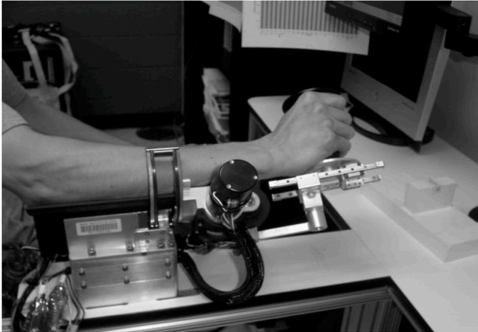
Figura 2.1 – Dispositivo para reabilitação do punho com três graus de liberdade (CHARLES et al., 2005).
