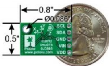
Figura 4.3 – Placa MinIMU com sensor de movimento.
