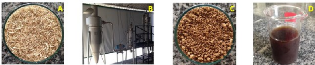
Figura 9: Biomassa não pré-tratada e produtos da explosão a vapor do bagaço de cana-de-açúcar.
