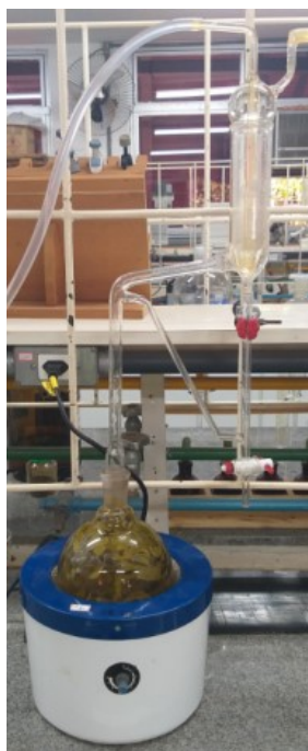
FIGURA 9- Aparelho de Clevenger utilizado para extração do óleo essencial de Eucalyptus urograndis .
