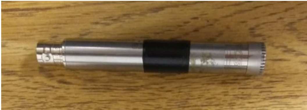
Figura 7 – Microfone PCB 377B02 com Pré-amplificador (Fonte: tirada pelo autor)
