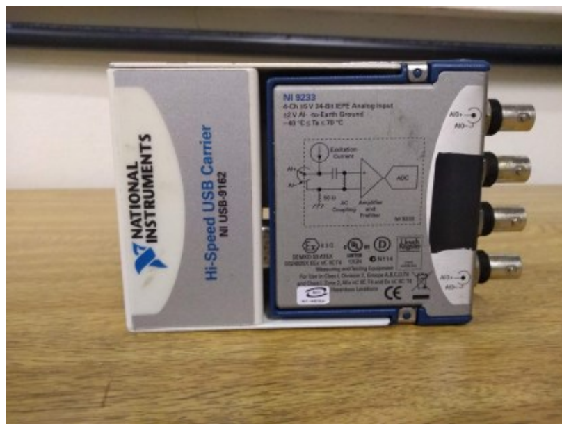
Figura 6 – Placa de Aquisição National Instruments USB-9162 (Fonte: tirada pelo autor)
