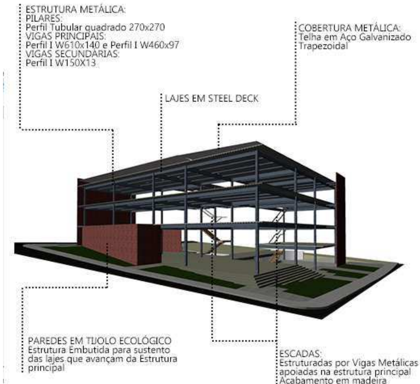
Figura 83: Esquema estrutural
