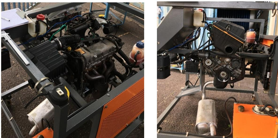
Figura 14 - Bancada experimental do motor Fiat Fire 1.0 localizada na Universidade Federal de Uberlândia (UFU).
