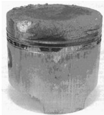
Figura 17 - Exemplo de danos causados pela detonação
