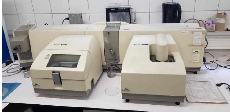
Figura 13. Equipamento para determinação do tamanho das partículas denominado Malvern .
