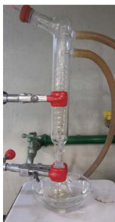
Figura 33 – Sistema de refluxo utilizado na preparação dos ésteres
