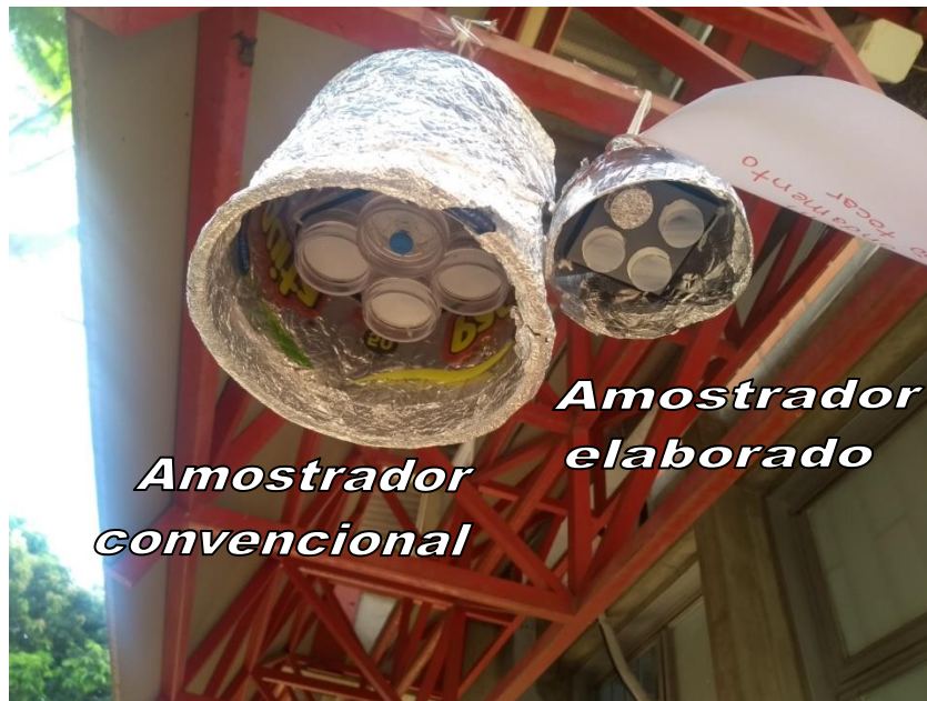
Figura 10. Amostradores posicionados nos suportes para amostragem.
