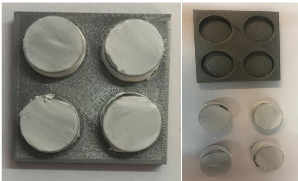
Figura 6. Amostrador construído a partir da Impressora 3D
