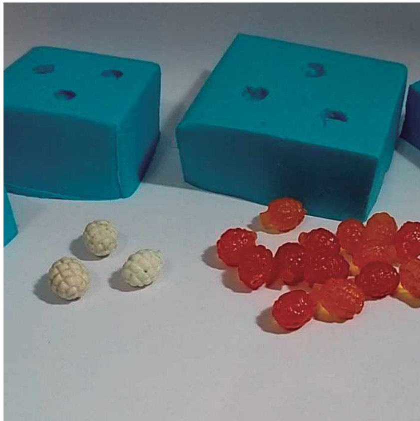
Peças matrizes em biscuit, moldes de silicone, e cópias em resina tingida. Execução, Rafael Gomes (2019)
