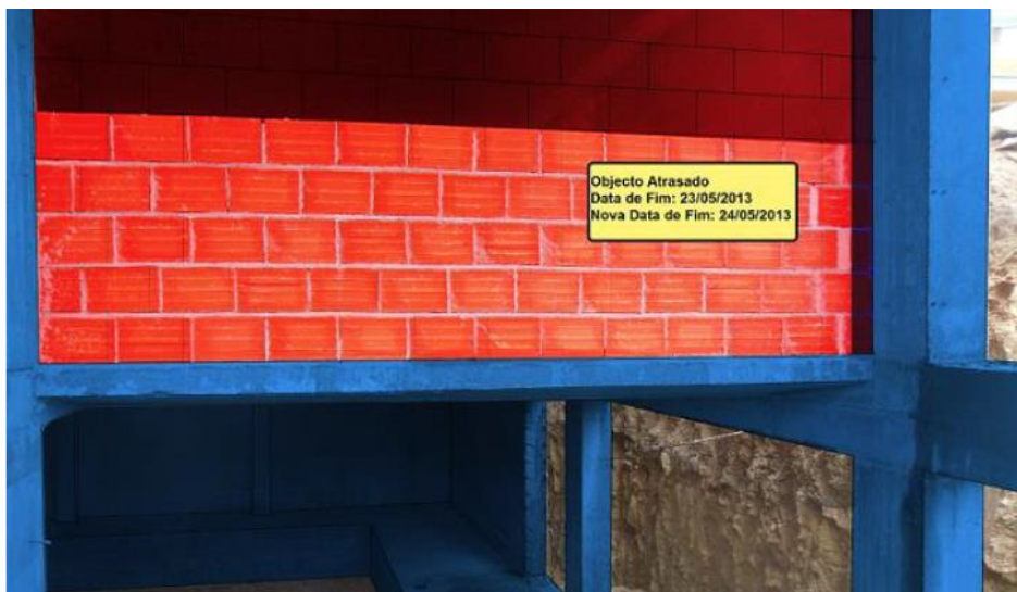
Figura 4: Tag de alerta de um elemento com não conformidade
