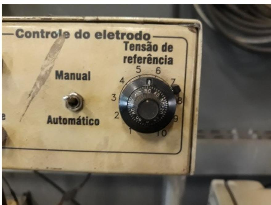
Figura 4.1 – Regulagem da tensão de referência
