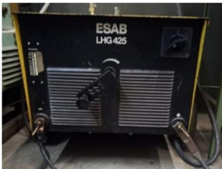
Figura 3.1 – Fonte de energia retificadora ESAB LHG 425
