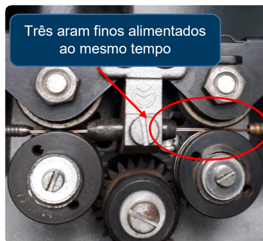
Figura 4.2 – Configuração com três arames de diâmetro nominal igual a 0,6 mm passando pelos roletes da máquina de soldagem
