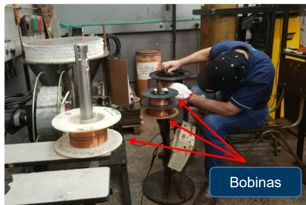
Figura 4.1 – Confeção de bobina com três arames finos enrolados simultaneamente
