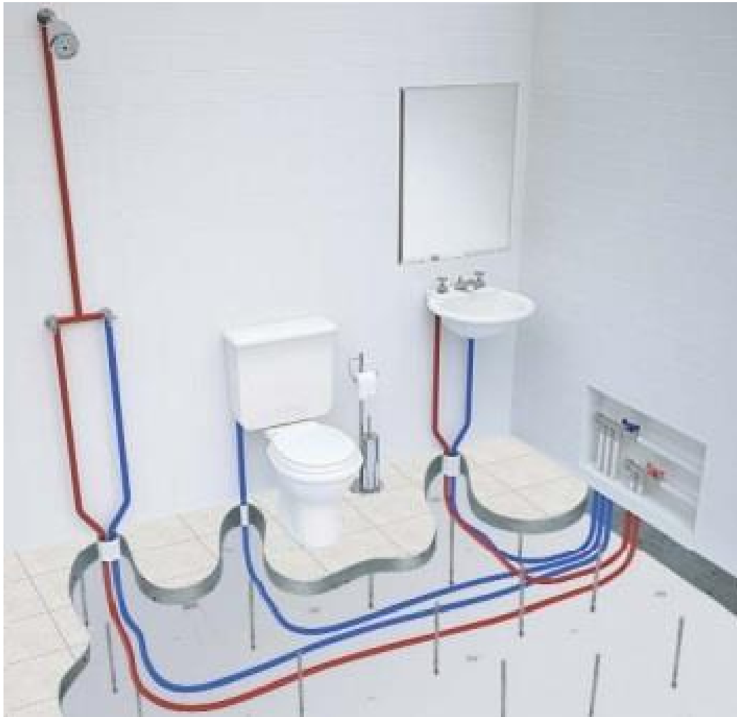
Figura 39: Exemplo de aplicação do Sistema PEX Fonte: Casa Ferreira Gonçalves (2019)
