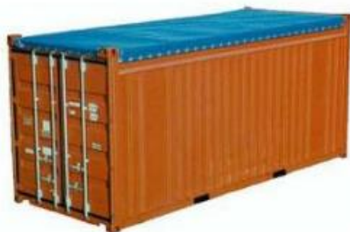
Figura 6: Container tipo “Open Top” Fonte: TUTOYA INTERNACIONAL TRADE (2015)
