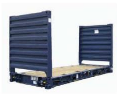
Figura 7: Container tipo “Flat Rack” Fonte: TUTOYA INTERNACIONAL TRADE (2015)
