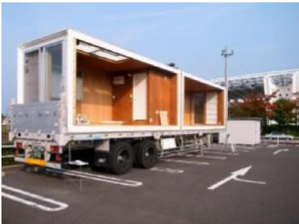
Figura 21: Transporte de dois contêineres de 20 pés sobre carreta rodoviária Fonte: DESIGNBOOM (2016)
